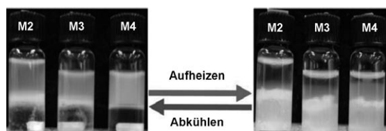
Abbildung 10. Aufnahmen des temperaturinduzierten Transfers von micellaren PEtOx- b -PNonOx-Aggregaten zwischen Wasser (obere Phase) und einer hydrophoben ionischen Flüssigkeit (untere Phase). Wiedergabe aus Lit. [140] .
